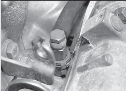
13.4a Hebeln Sie die Federklemme der Einspritzdüse hoch ...
