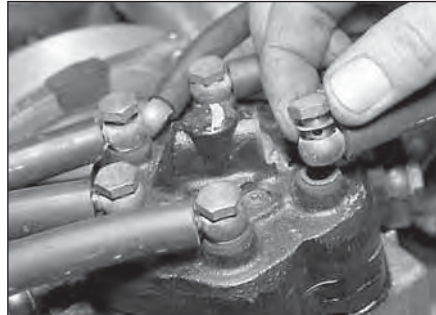
13.9a Lösen Sie den Anschluss der Einspritzdüsen-Leitung – beachten Sie die Dichtscheiben.
