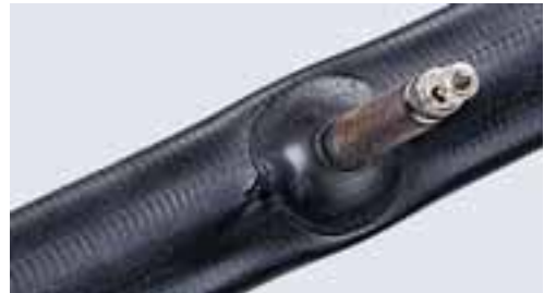
Dieser Schlauch war auf einer glatten Felge ohne Felgenband montiert und ist am Übergang von der Ventilverstärkung zum Ventil geplatzt.
