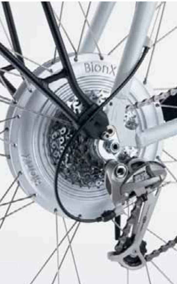
Etwas bulliger als eine herkömmliche Hinterradnabe ist der BionX-Hinterradnabenmotor.
